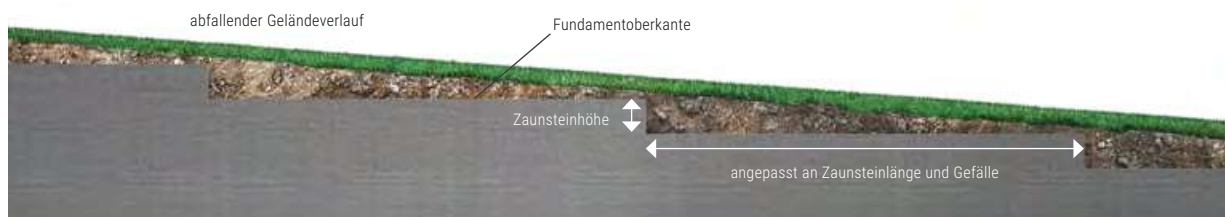
Abbildung 8: Abgestuftes Fundament bei einem Gefälle
