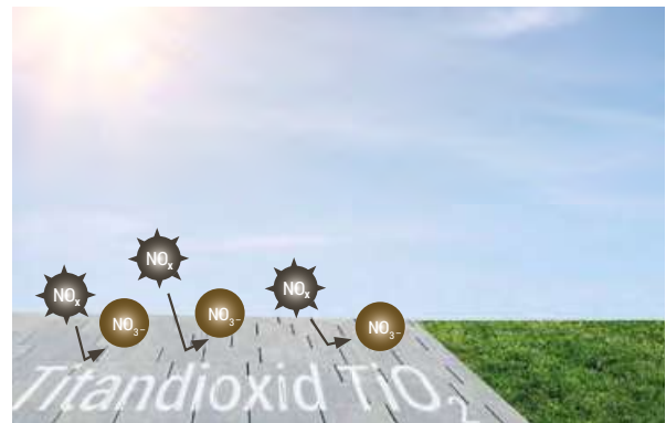
Mithilfe von Sonnenlicht wandelt Titandioxid ( \text{TiO}_2 ) Stickoxide ( \text{NO}_x ) in Nitrat ( \text{NO}_3^- ) um.
