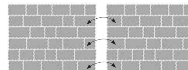
Bei maschineller Verlegung sind Steine zu tauschen, um eine durchgehende Fuge zu vermeiden.
