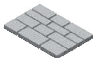
Querformat: Um eine durchgehende Fuge zu vermeiden, müssen bei maschineller Verlegung 2 Steine pro Lage getauscht werden.
