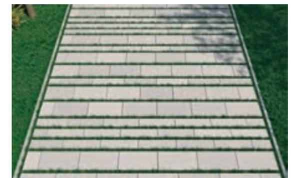
LINEA VG4 Pflasterplatte 60 x 15 x 8 cm und 60 x 30 x 8 cm in unregelmäßige Bahnen mit 55 mm breiten horizontalen Fugen verlegt.
