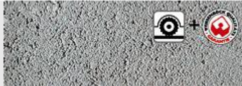
Kő felülete erős mechanikai behatások után.
