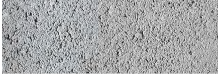
A köfelület erős mechanikai terhelés után, Weissenböck kő.
