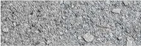
A köfelület erős mechanikai terhelés után, egyéb köveknél.
