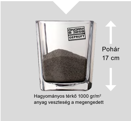
A köfelület erős mechanikai terhelés után, egyéb köveknél.
