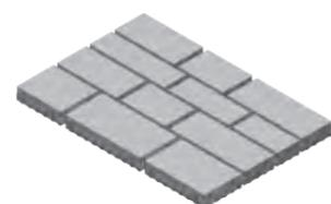
Querformat: Um eine durchgehende Fuge zu vermeiden, müssen bei maschineller Verlegung 2 Steine pro Lage getauscht werden.
