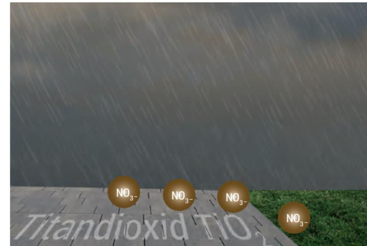
Regenwasser transportiert das Nitrat ( $\text{NO}_3^-$ ) von der Fläche. Es wird nicht mehr Nitrat freigesetzt als durch den natürlichen Abbau von  $\text{NO}_x$ . Das Nitrat dient den Pflanzen als Nährstoff.
