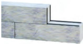
Das Aufbringen des wasserbeständigen Universal Kleb- u. Dichtstoffs z. B. STÖ Nr. 1\* erfolgt in Streifen.
