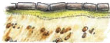
Verformungen, die durch ungleichmäßige Bettungsdicke entstehen, nach Benutzung.
