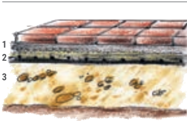
Verlegung im Mörtelbett – 1 Mörtel, 2 Drainbeton gem. RVS 08.18.01, 3 ungebundene untere Tragschicht
