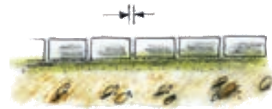
Richtig, da die Steine mit genügendem Fugenabstand verlegt wurden. Mindestfugenbreite je nach Format und Anforderung bei ungebundener Bauweise 5 – 8 mm, bei gebundener Bauweise 8 – 15 mm (lt. ÖNORM B 2214)
