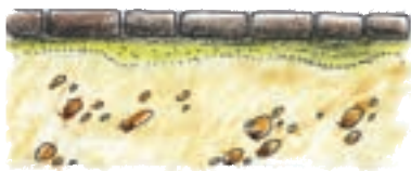
Verformungen, die durch ungleichmäßige Bettungsdicke entstehen, vor dem Abrütteln.
