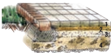
Randausbildung – 1 Pflasterbelag, 2 Splittbett ca. 3 – 6 cm, 3 ungebundene obere Tragschicht, 4 ungebundene untere Tragschicht ca. 30 – 70 cm
